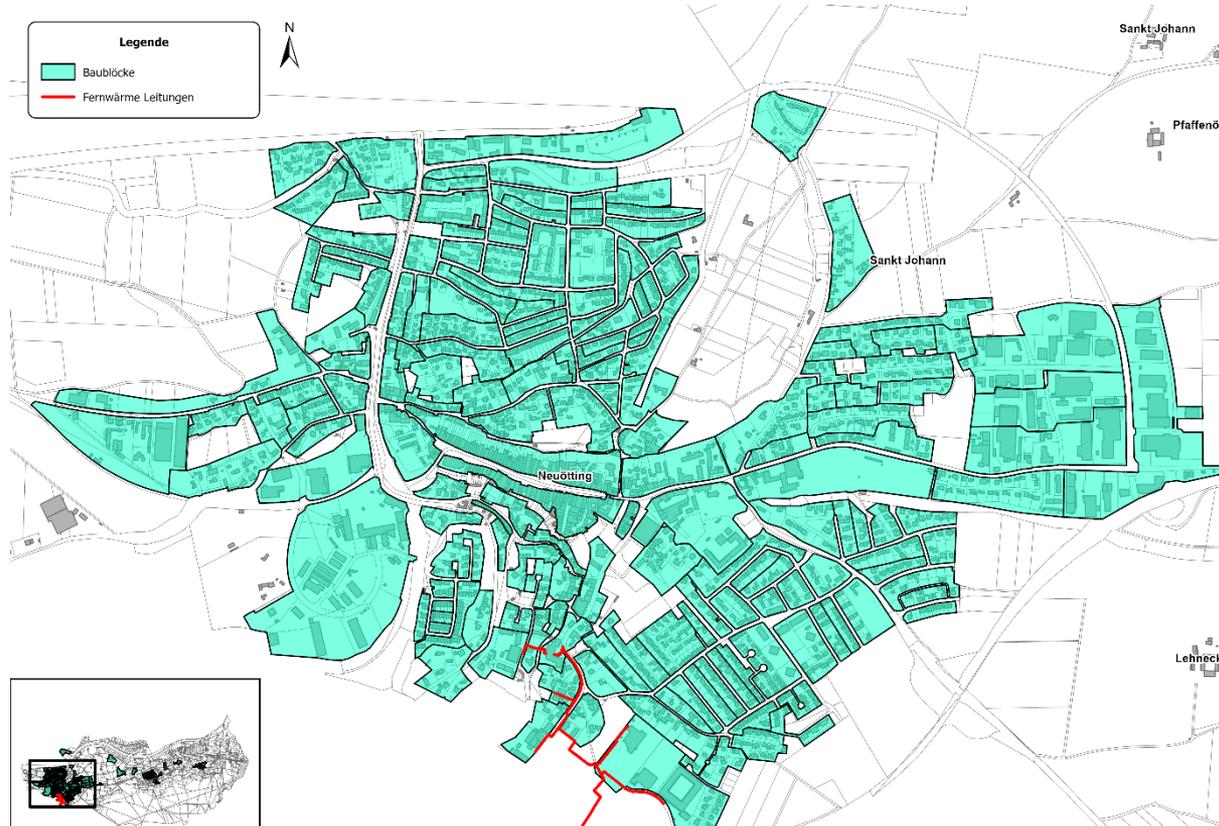
*Die Baublöcke orientieren sich an einer fiktiven Verlegung von Fernwärmeleitungen*
